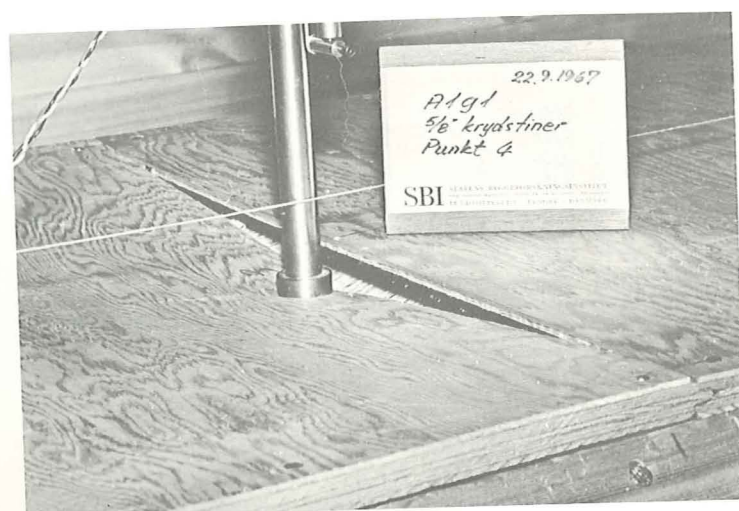
Fig. 22. Typisk brud for statisk punktlast ved fuge af et krydsfinerundergulv. Bruddet indledtes ved flækning i noten.
