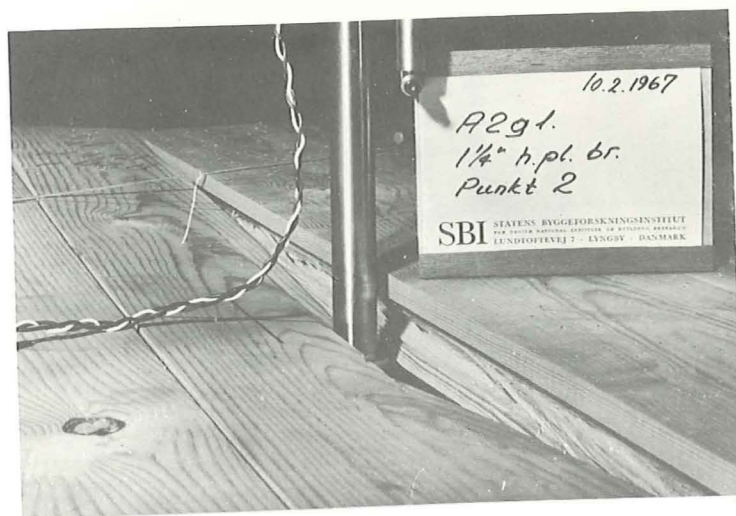
Fig. 20. Typisk brud for statisk punktlast på gulvbrædder. Bruddet indledtes ved flækning i fer eller not.
